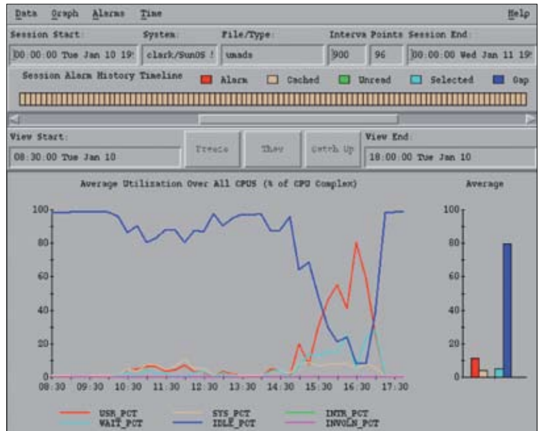
Abbildung 5: Ein Measurement Application Program, das die Prozessorauslastung als Zeitreihe und Histogramm zeigt. Ein Schieberegler ermöglicht es, historische Daten einzublenden.
